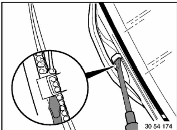
Sicherungsklammer von außen abziehen.
