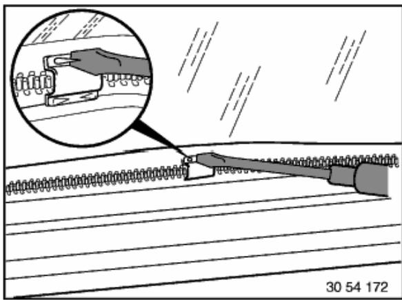
Vier Krallen der Sicherungsklammer, an der Heckscheibeninnenseite unten Mitte, mit Schraubendreher aufbiegen.
