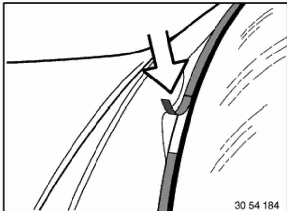
Dichtband 100 mm auf Sicherungsklammer bündig mit Profilkeder aufkleben und Schutzfolie abziehen.
