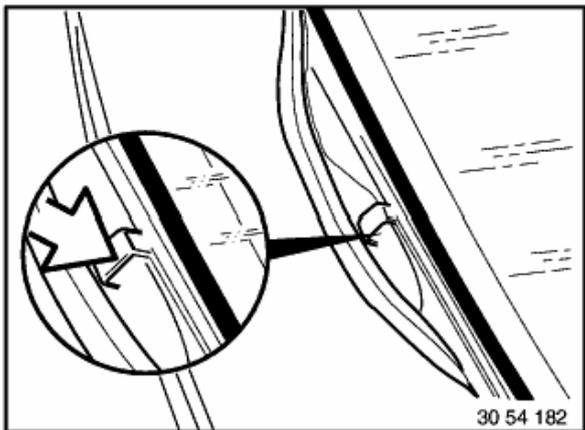
Sicherungsklammer von außen durch Reißverschluß stecken.
