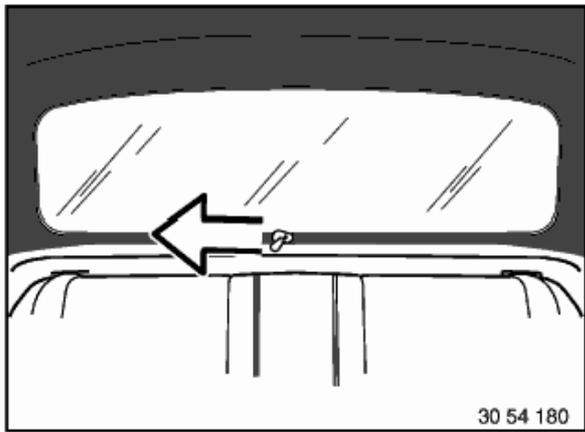
Reißverschluß langsam schließen und Reißverschlußschieber entfernen.
