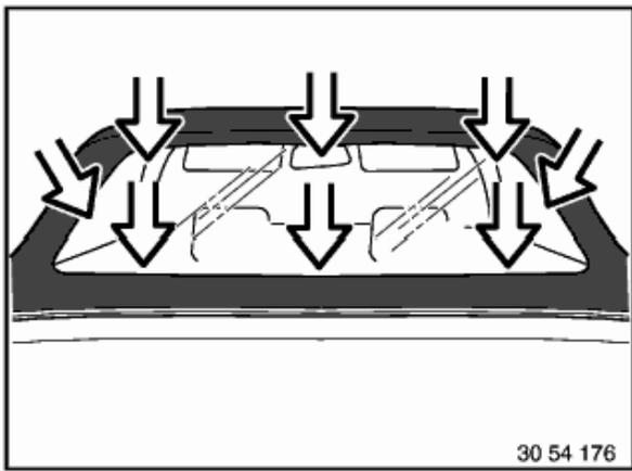
Heckscheibe von außen durch leichten Druck lösen und nach innen herausdrücken.
